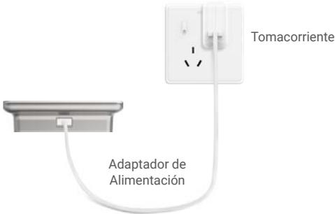
Conecte el panel al tomacorriente mediante un adaptador de alimentación (5V 2A, se vende por separado).
