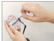
Ajuste los tornillos en la parte trasera de la cámara.
